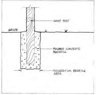
Figure 4.10. Concrete Backfill
