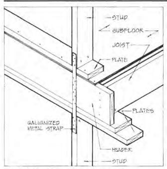
Figure 4.44. Stud-to-Stud Connections
